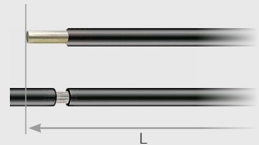
Voll- oder Teilabisolierung Complete or partial stripping
